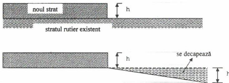
În plan, liniile de decapare se recomandă să fie în formă de V, la 45°. Completarea zonei de unire se va face prin amorsarea suprafetei, urmată de așternerea și compactarea noii mixturi asfaltice, până la nivelul superior al ambelor straturi (nou și existent).
